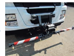
Rampe de lavage pour le nettoyage des routes
